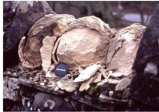
Efekt sukcesywnego wietrzenia mrozowego ukazany na porowatej skale wapiennej. (Fot: Peter Kennett)
