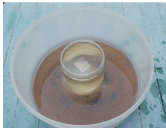
Model „nieskończonego meandru rzecznego” z równomierną warstwą piasku i cięższych cząstek.
