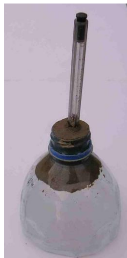
Samodzielnie przygotowany lejek, wykonany z górnej części plastikowej butelki, rurki długopisu oraz gliny (Zdjęcia: P. Kennett)
