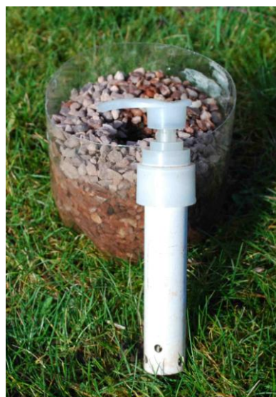
Perforacje w rurce wykorzystanej w prostym modelu, zapobiegające jej zatkanie.
