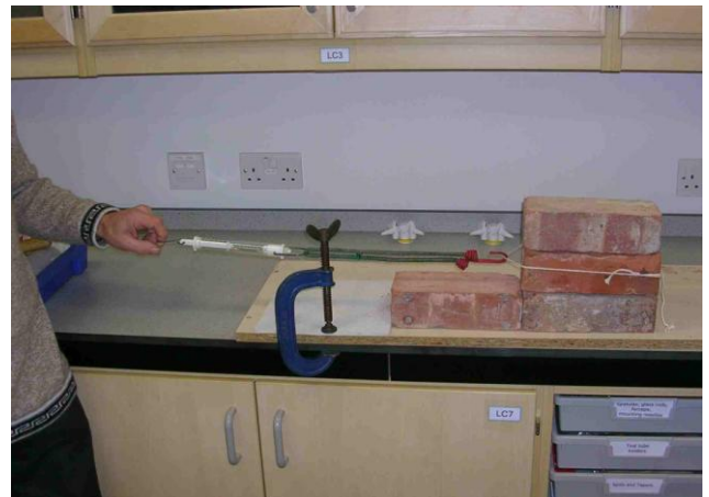
Fot. 2. „Trzęsienie ziemi” w akcji, z użyciem siłomierza w celu ustalenia wielkości siły przyłożonej do cegły. Cegła znajdująca się z przodu jest zablokowana, co uniemożliwia jej przesuwanie. (Fotografie: P. Kennett)
