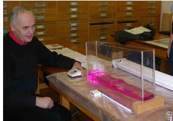
Fot. 1. Mierzenie prędkości fali w plastikowym zbiorniku (fot. P. Kennett).
