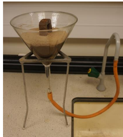
Fot. 3. Prosta wersja zestawu do badania wpływu ciśnienia wody w porach na osad. (Fot. Chris King)
