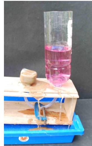
Fot. 4. Od lewej: A) Bardziej wyrafinowany, ręcznie skonstruowany aparat, gotowy do zamknięcia zacisku i napełnienia zbiornika wodą. B) Moment przed zwolnieniem zacisku. C) Kilka sekund później, po zwolnieniu zacisku, „budynek” zatonał w osadzie w wyniku wzrostu ciśnienia wody w porach pomiędzy ziarnami piasku. (Fotografie: Peter Kennett)
